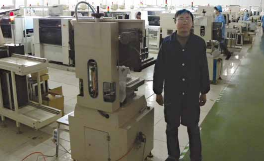
■ خط انتاج في غرفة smt . كيان ينج مسؤول هنا و يخبرنا " نعمل باستخدام آلتى ياماها اليتين ، ستة آلات من جوكي ، التين من باناسونيك وخط للاختبارات و الاصلاح . باستخدام هذه الآلات يمكننا انتاج سبعة ملايين قطعة في الشهر .
