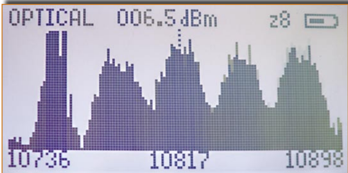
عرض الطيف الترددي spectrum للاشارة في مدى ترددي عمودي باستخدام أعلى مستوى للتكبير
