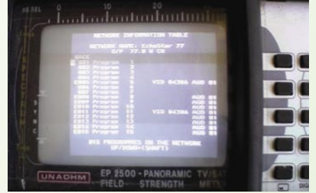
جهاز قياس الإشارات للسيد Diego يظهر لنا الجدول الشبكي للنطاق الذي يستقبله من القمر ECHOSTAR 6A .
