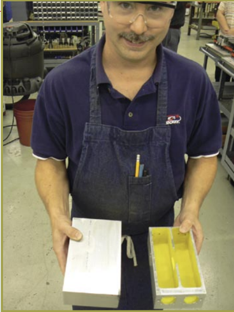
■ السيد Dale Newton يرينا تتابع الإنتاج : جسم الفلتر من الألومنيوم ( على اليسار ) و على اليمين الفلتر كامل مع فتحات للموصلات و الصواميل
