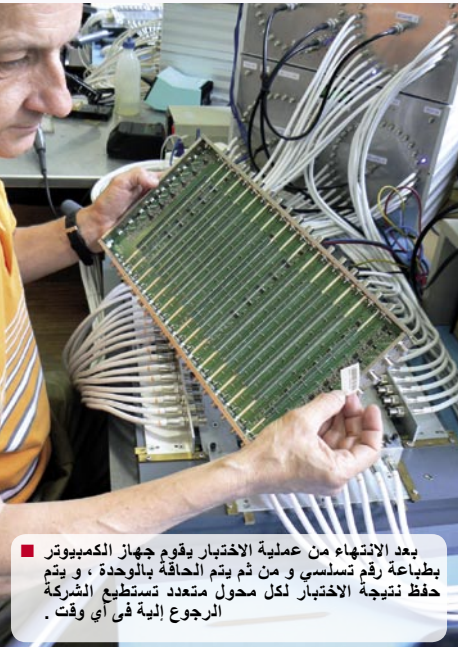
■ يتم اختبار كل محول متعدد من حيث وظائفه المتعددة و يتم وضع كل سويتش داخل محطة الاختبار و يتم إدخال كل موصلات "F" للاختبار .
