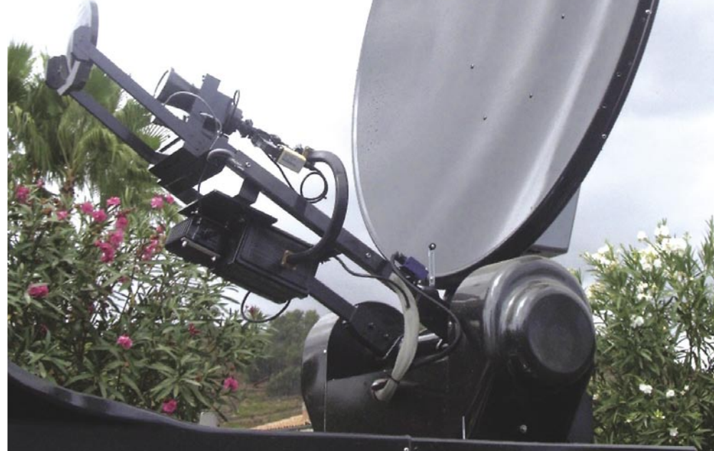
طبق بقطر 150سم متحرك يفتح بطريقتة آلية ليجد القمر الصناعي أوتوماتيكيا
