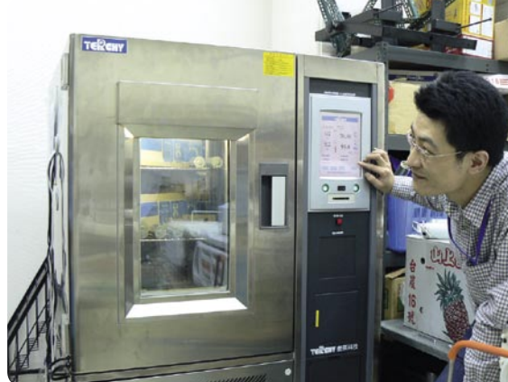
تؤخذ عينات من خط الإنتاج و يتم اختبارها في غرفة باردة و حارة ، هنا يوجد فرن تسخين حتى 70 درجة مئوية و يتم الاختبار في درجة حرارة من -40 إلى +90 درجة مئوية
