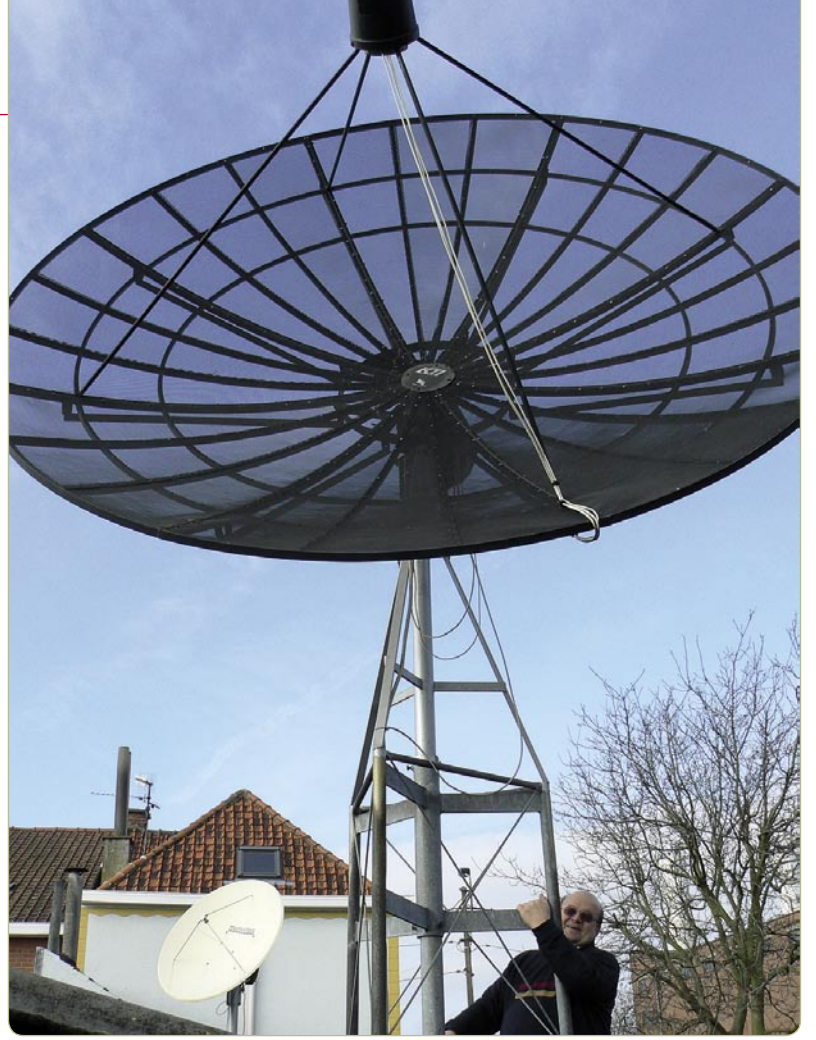
يقول السيد / Aimé إن الطبق ضخم و من الصعب ضبط تثبيته وحدة خفض الشوشرة و فى الجزء الأيسر من خلفية الصورة يمكنك أن ترى طبق متحرك آخر بقطر 1ر8 متر لاستقبال Ku-band.
